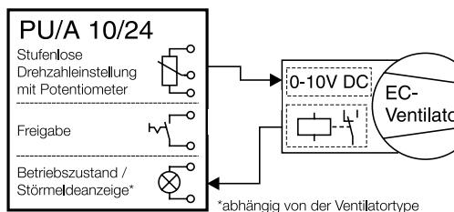
Zur stufenlosen Steuerung bzw. Regelung von ein- und dreiphasigen EC-Ventilatoren mit einem Sollwerteingang von 0–10 V DC. Anschlussbeispiele sind aus den unten aufgeführten Prinzipschemata ersichtlich.
