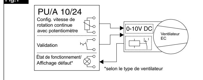
Pour la commande continue : paramétrage des ventilateurs mono ou triphasés avec une entrée de consigne de 0-10 V DC. Les exemples de raccordement se trouvent ci-dessous.
