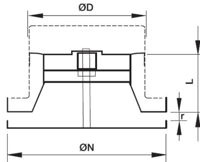
Das Ventil ist geschlossen, wenn der Teller des Ventils von der Null-Ebene platziert ist. Bei vollständiger Öffnung ist der Abstand 25 mm von der Null-Ebene platziert. Eine Umdrehung des Ventiltellers entspricht in etwa 1 mm Abstand. Die Grafik zeigt die Abhängigkeit der Strömungsrate, Schallpegel und Gesamtdruckverlust am Ventil Typ **DVSR100 und DVSR125**
